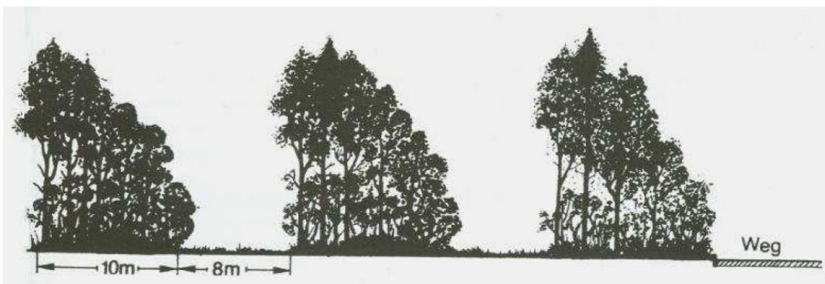
Figuur 12: Trapsgewijze beplante en onbeplante vegetatiestroken ter bevordering van de geluidsreductie (Vaes, 2001)
